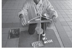
2. まいぎりの上端をもってクルクル回転させ、紐を棒に巻きつけます。そして、横木を両手でしっかり握って上下に動かします。この時、紐が元に戻る反動を利用し、継続して動かすことがコツです。
